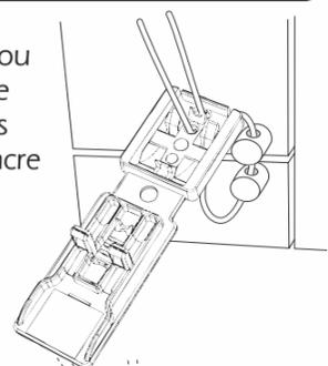
2- Internamente trançe o arame por uma vez. Siga com as duas pontas até a outra extremidade do lacre e passe pelos dois orifícios de saída (B ou C) (cada ponta em um orifício).
